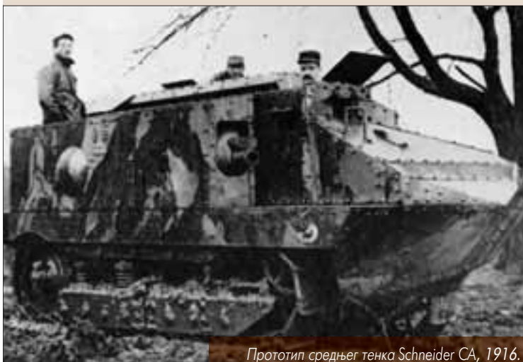
Прототип средњег тенка Schneider CA, 1916.
